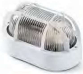
APLIQUE OVAL EXTERIOR IP44 Portalámparas E-27 60 W Blanco. Termoplástico con vidrio transparente y reflector interior de aluminio. 183 x 112 x 108 mm. Color blanco.
